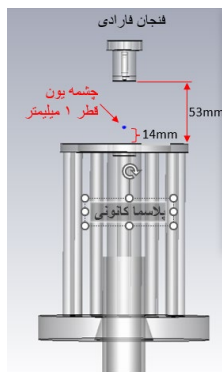
شکل ۱: محل قرار گیری فنجان فارادی در بالای پلاسمای کانونی و تشکیل پینچ
